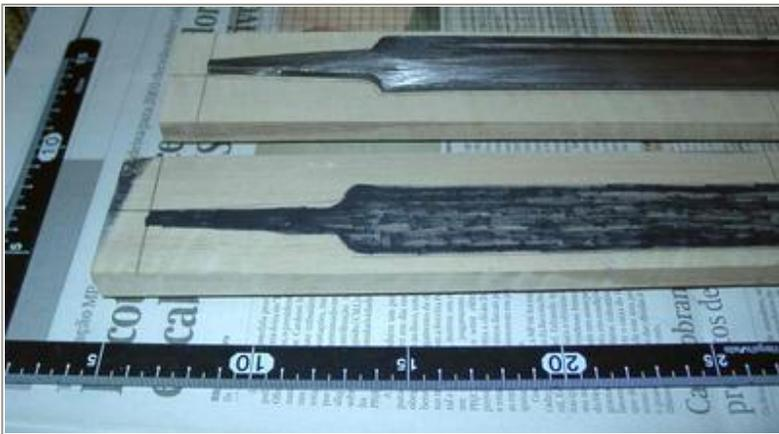
Os dois pedaços de madeira já foram riscados e o próximo passo é fazer o desbaste da parte interna do risco.
