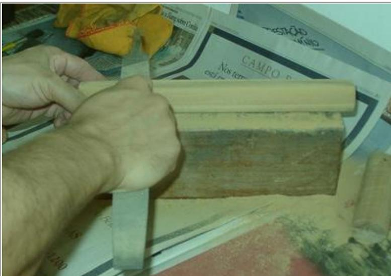
A madeira já está na espessura e o próximo passo é usar as lixas para madeira.
