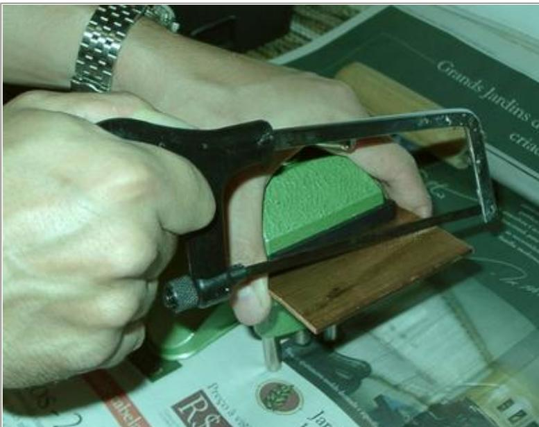
Para fazer o habaki vou usar o cobre por ser de fácil desbaste e tem boa plasticidade. A placa é presa e serrada em um tamanho superior ao dobro da espessura da lâmina. Exemplo se a lâmina tiver 3cm de largura a placa deve ter no mínimo 7cm a altura do habaki depende do tamanho da lâmina no caso o habaki terá 3cm de altura .
