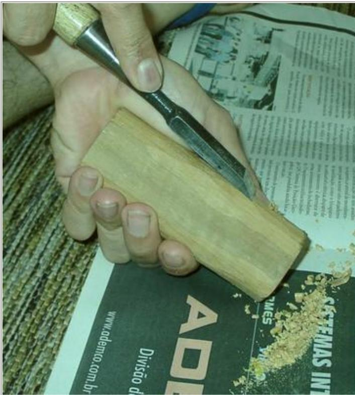
Depois de colar as duas peças do cabo e retirado o excesso de material usando o formão.
