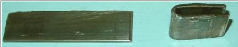
Com o auxílio de dois alicates a placa de cobre é dobrada.
