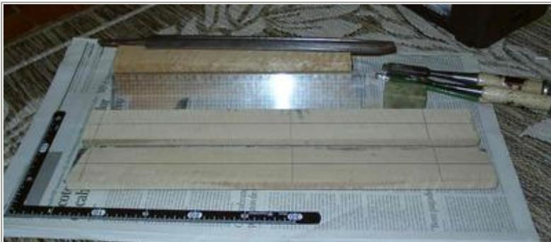
Agora o pedaço de madeira será riscado, é feito um risco de 45cm de comprimento. Esse risco divide a madeira em dois lados, cada lado com 2,5cm. O próximo passo é fazer três riscos, um para definir até aonde vai o cabo, o outro o meio da lâmina e o último onde fica a ponta da lâmina, essas medidas variam de acordo com o tamanho da lâmina.
