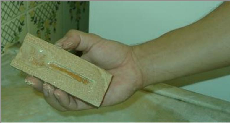
Próximo passo vou nivelar o cabo, é importante nivelar a bainha e o cabo para que na colagem a madeira encaixe perfeitamente. Para nivelar vou usar areia fina com água na pia da cozinha ,esse processo pode ser feito colando uma lixa em uma superfície plana.
