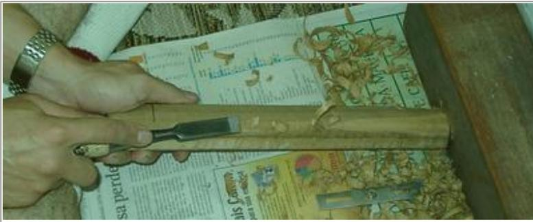
Depois de colar os dois pedaços da parte da bainha uso um formão para retirar o excesso de madeira .
