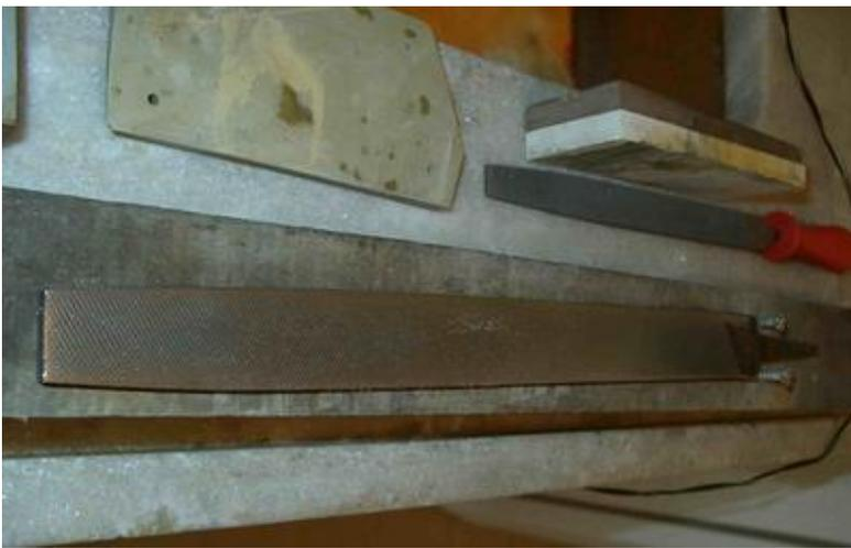
Para fazer o desbaste irei usar um caibro de madeira com dois parafusos fixados nela, os parafusos servirão para segurar a lima .
