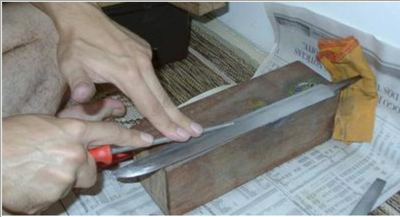
O desbaste deve ser feito usando uma certa pressão na lima e com uma inclinação parecida com a da foto.
