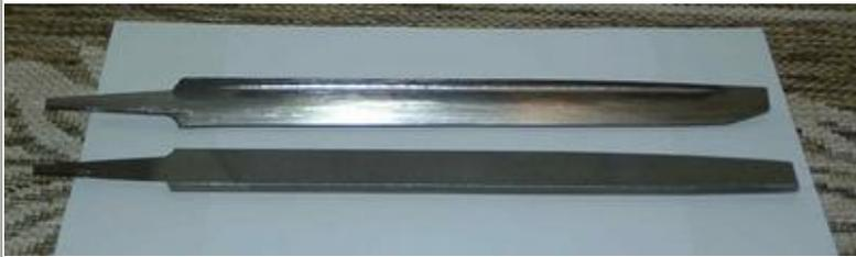
A lâmina já está com o formato desejado. Essa lâmina terá um veio na parte mais grossa. É usado um lápis para marcar o veio e depois é colocado fita isolante na lâmina. A fita é colocada nos dois lados do risco, deixando pelo menos dois milímetros entre uma fita e outra. No pequeno canal que ficou é passada a lima redonda, o trabalho deve ser feito com bastante cuidado para que o risco fique perfeito. Dá trabalho, mas fica muito bonito.
