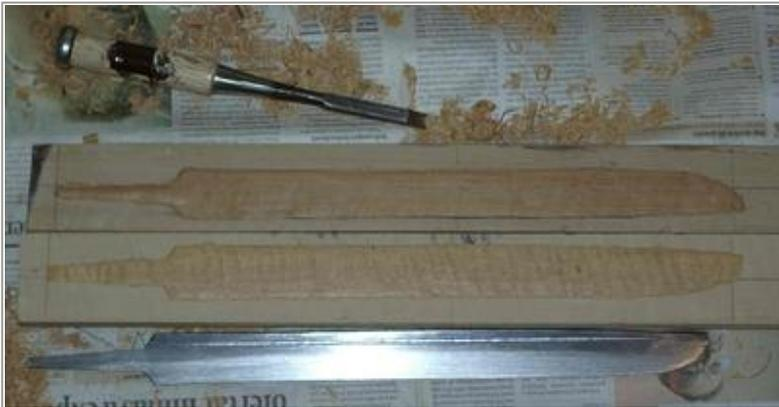
As duas peças estão completas , a lâmina deve encaixar perfeitamente dentro dos moldes.
