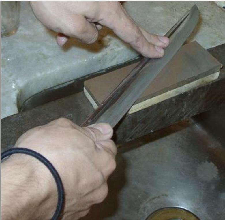
Depois de todo o processo de desbaste foi feito a têmpera. Depois da têmpera a lâmina ficou com pequenas imperfeições que são corrigidas com o uso de uma pedra número 220.
