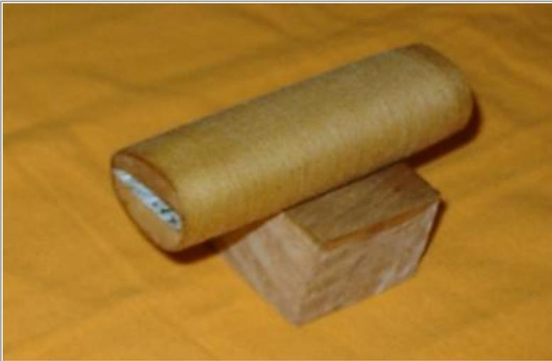
Depois o cabo é laqueado novamente para que o encordoamento não solte, o cabo já foi furado anteriormente e depois que a goma laca seque será feito um furo no encordoamento para passar o pino de bambu que ira segurar a lâmina.
