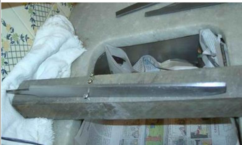
Na etapa seguinte vou fixar quatro parafusos no caibro de madeira. Esses parafusos servirão para segurar a lâmina em várias posições. No caso da foto ao lado a lâmina é presa de forma que possibilita o desbaste dos cantos da lima
